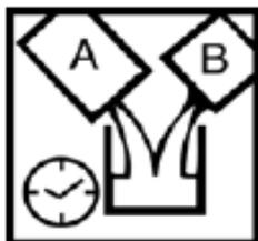
Pesar primeiramente os concentrados coloridos/base branca e homogeneizar. Posteriormente, adicionar gradativamente a quantidade pré-definida de Clear Fosco para PU (SW887) até obter o brilho desejado e homogeneizar novamente. Completar a fórmula utilizando o Clear da respectiva linha.
